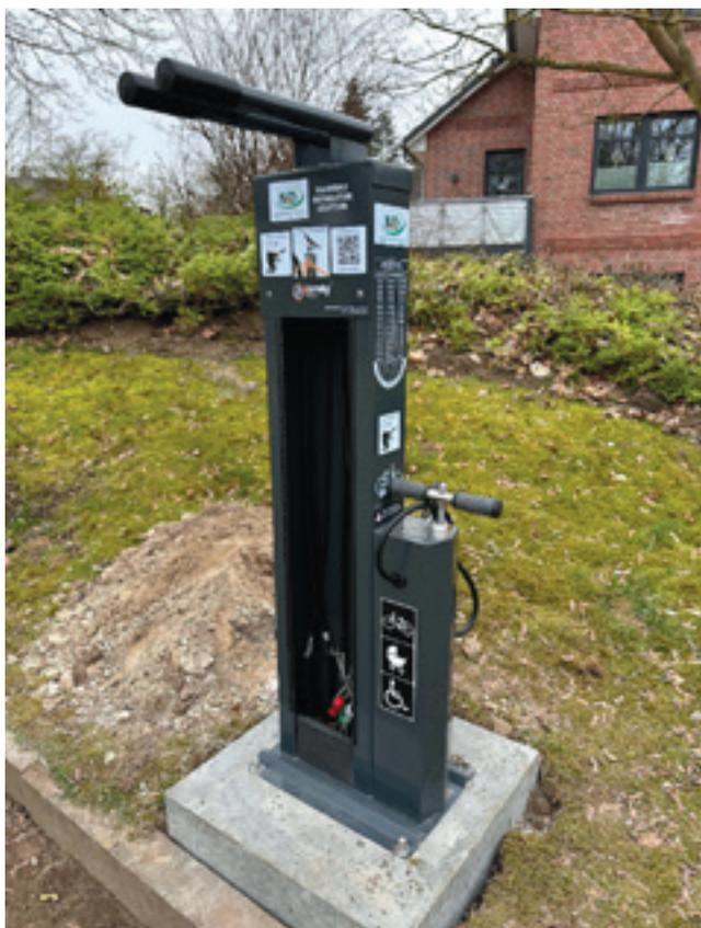
worden. Sie bietet nicht nur Radfahrer\*innen die Möglichkeit wieder Luft auf platte Reifen zu pumpen, sondern mit den vorgehaltenen Werkzeugen kann man auch kleinere Reparaturen durchführen. Gleiche Stationen sind nun auch in den anderen Dörfern der Probstei aufgebaut worden. Bezahlt wurden sie von nicht abgerufenen Fördermitteln für Fahrradwege und haben für die Gemeinden deshalb keine Kosten verursacht.
